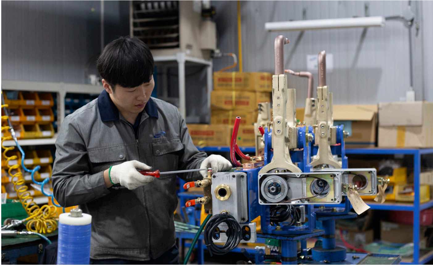
강병규 사원(31)이 Spot Welding Servo Gun을 조립하고 있다.
