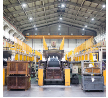
금속을 녹는점보다 약간 낮은 온도로 가열한 다음 천천히 식히는 소둔로(燒鈍爐)의 추출부 모습
