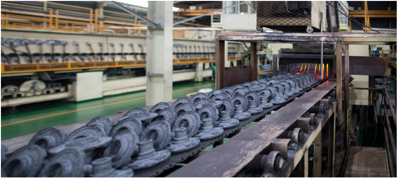
공정조직의 균질화 및 기계적 성질을 개선하는 노멀라이징 열처리 공정
